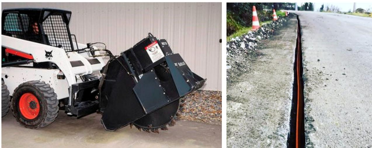
Figura 06 – Macchina operatrice per esecuzione di minitrinca
